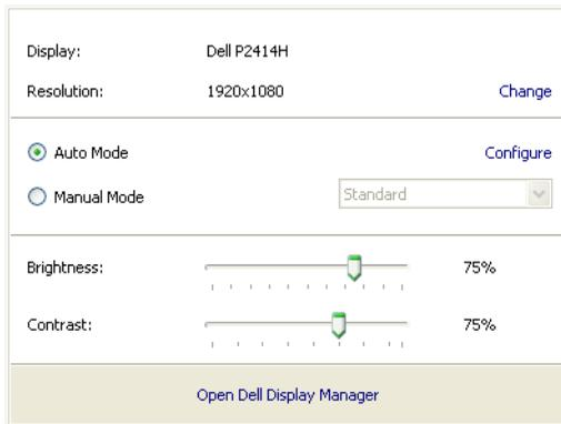
El cuadro de diálogo de configuración rápida también ofrece acceso a la interfaz avanzada de usuario de Dell Display Manager, la cual se utiliza para ajustar funciones básicas, configurar el Modo automático y acceder a otras funciones.
